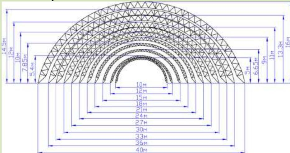
Быстровозводимые тентовые ангары состоят из разборного металлокаркаса на болтовых соединениях и покрытия из высокопрочной тентовой ткани с ПВХ пропиткой.
